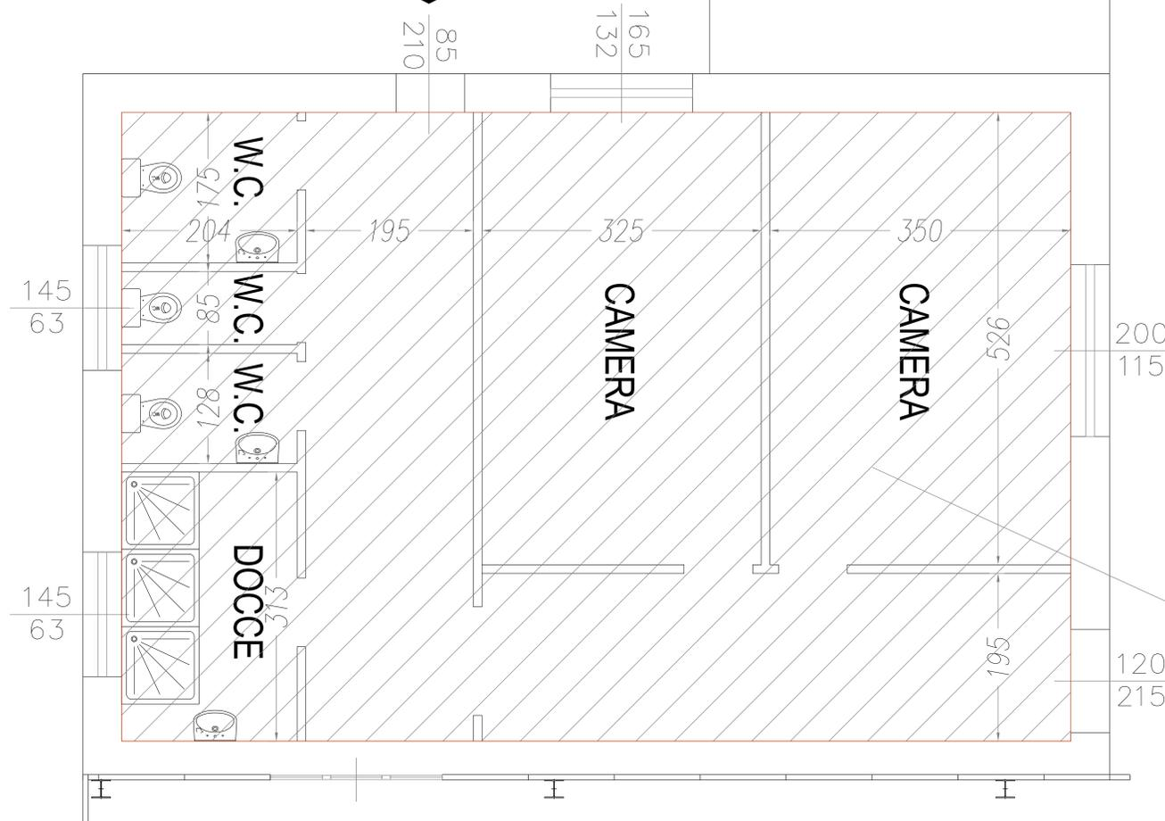
DEMOLIZIONE DI TUTTI I TRAMEZZI, DELL'IMPIANTO ELETTRICO E DI TUTTI I SANITARI
